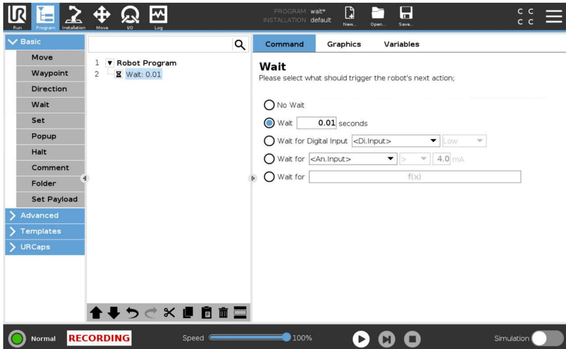
6. Die Anzeige am TP wechselt von RECORDING zu SAVING. Die Daten werden im ZIP-Format komprimiert und auf den USB-Stick geschrieben. Entfernen Sie während dieses Schritts nicht den USB-Stick.
